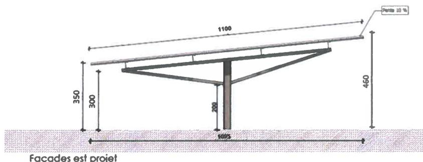
Les panneaux photovoltaïques auraient une puissance globale de 250 kilowatt-crête avec une production annuelle d'électricité estimée à 301 mégawatt-heure, soit l'équivalent de la consommation électrique annuelle (hors chauffage) d'une centaine de foyers.
